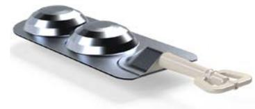
El envase blíster se desarrolló conjuntamente con el fabricante de maquinaria **Rohrer - Leading Solutions**. Una celda se llena con un polvo seco que incorpora el ingrediente activo (muy sensible a la humedad), la otra con líquido. Al liberar el cierre frangible, se abre el canal y ambos componentes se mezclan presionando sobre las celdas.
